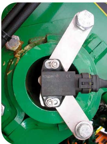
» **Sensor de velocidade da semeadora-adubadora – sensor de rodas**
