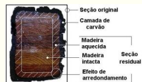
Seção de uma viga de madeira laminada colada, exposta ao fogo durante 30 minutos.
